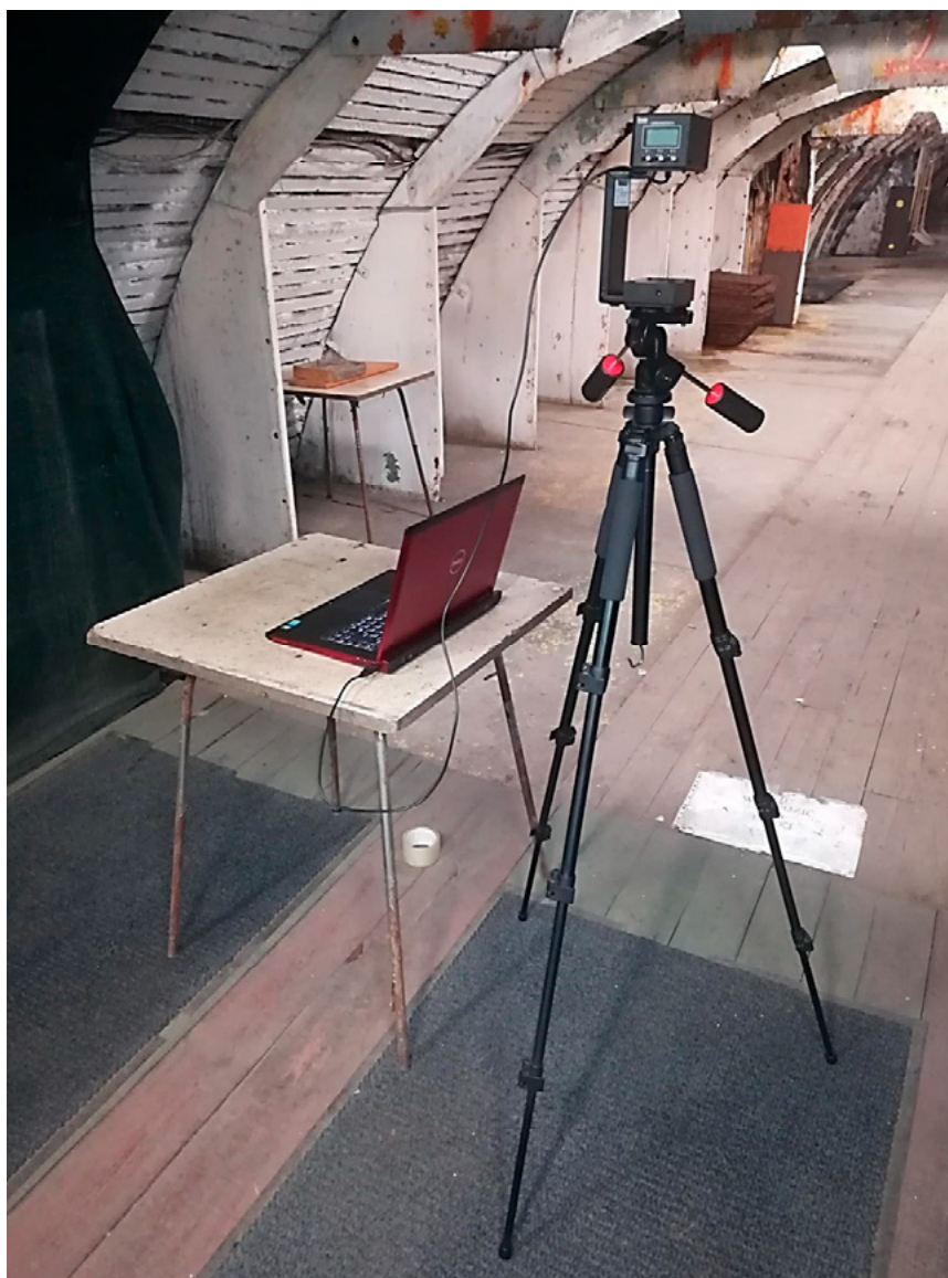
Fig. 9. Bullet velocity measurement set Ryc. 9. Zestaw do pomiaru prędkości pocisków
